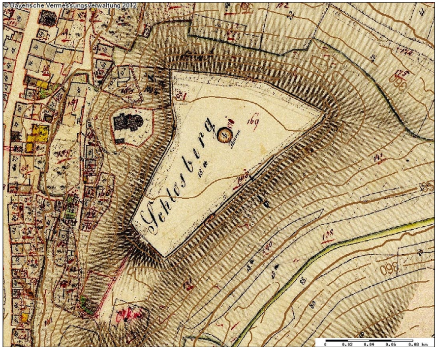
Abb. 10: Bad Abbach, „Schlossberg“. Ausschnitt aus dem Urkataster mit übergelegten Höhenlinien. Die Darstellung der Hänge in Schraffenmanier vermag die Hanggräben und Außenwälle nicht genauer wiederzugeben (Geodaten: Landesamt für Vermessung und Geoinformation München).
