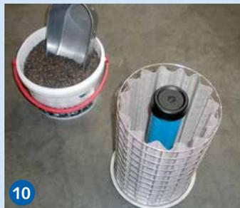
10 Substrat in den Ringraum einfüllen.
