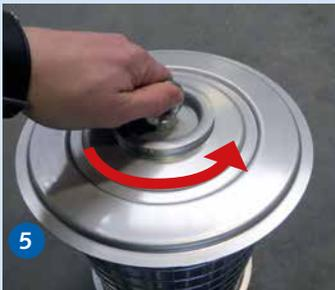
Die Ringmutter lösen und den Deckel der INNOLET®-Filterpatrone abnehmen.
