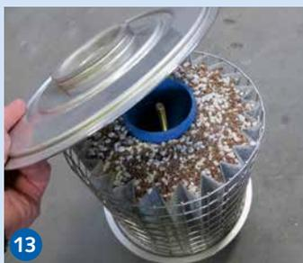
13 INNOLET®-Filterpatrone mit dem Deckel verschließen und die Ringmutter festdrehen.
