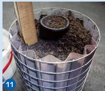
11 Substrat leicht verdichten. Die Filterpatrone muss bis zur Oberkante gefüllt sein.
