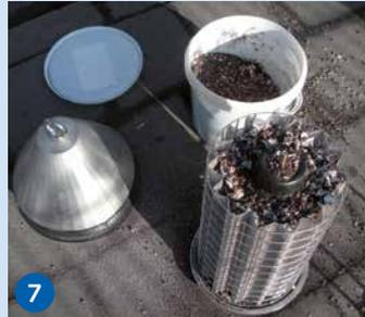
INNOLET®-G-Filterpatrone wie folgt mit Substrat füllen: Ringmutter lösen, den oberen Deckel abnehmen und die schwarze Kappe aus dem Substrateimer auf das blaue Sickerrohr aufsetzen. Substrat einfüllen (7), leicht verdichten bis der ganze Eimerinhalt hineinpasst und die Kappe wieder entfernen. Anschließend den Deckel auflegen und die Ringmutter wieder aufschrauben.
