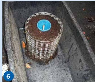
Das alte Substrat aus der Filterpatrone entfernen, z. B. in einen Behälter füllen.
