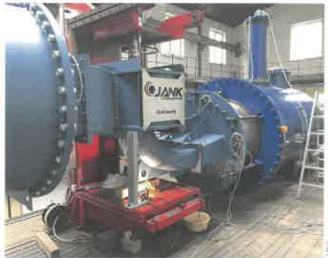
Bild 4: Eingebaute Modellturbine am Dieter-Thoma-Labor der TU München
