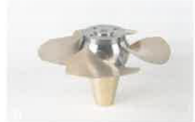
Bild 8: Prototypenanlage: a) Krafthaus mit PM-Generator im Vordergrund, b) 3-Flügler-Laufrad, c) Einlaufspirale, d) 4-Flügler-Laufrad
