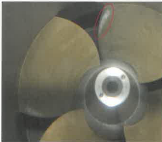
Bild 6: Photographische Dokumentation einer Eintrittskantenkavitation bei Teillast
