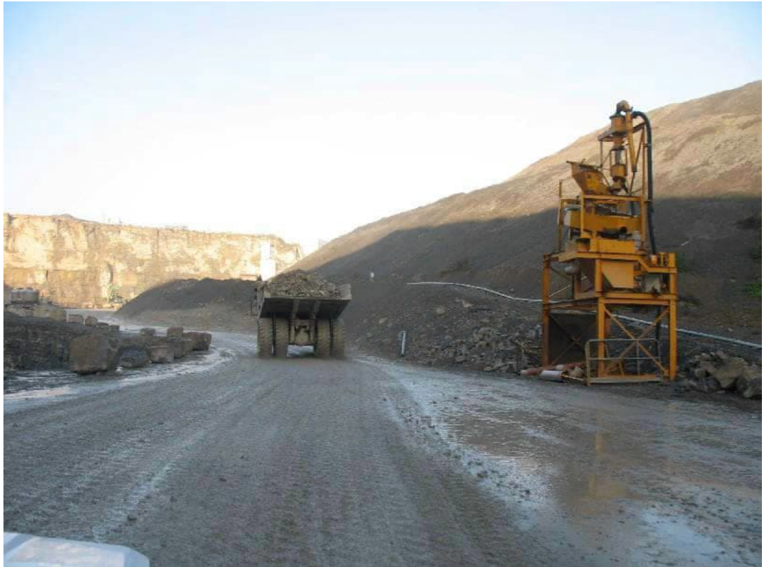
Abbildung 5. Fahrverkehr in einem Steinbruch, bei nassen unbefestigten Fahrwegen sind keine sichtbaren Staubemissionen feststellbar [26].
