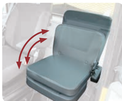
Ist der vollwertige Beifahrersitz zusammengeklappt, kann der Fahrer bequem ins Fahrerhaus einsteigen und hat freien Zugriff auf den Luftfilter der Klimaanlage und das Staufach
